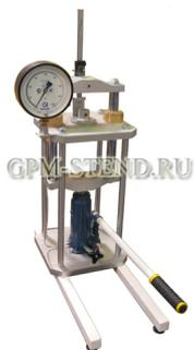
Типовой комплект учебного оборудования МСМ «Механические свойства материалов» включает с себя учебный стенд МСМ «Механические свойства материалов» и методические рекомендации по проведению лабораторных работ. Стенд предназначен для проведения лабораторных работ по изучению способов определения механических свойств материалов. Одновременно работы проводятся с группой из 2...3 обучаемых.
