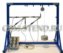
Учебный стенд «Напряжения в плоских фермах» СМ-НПФ-014 предназначен для проведения лабораторных работ по изучению напряженного состояния в элементах ферменных конструкций в рамках лабораторных работ курса «Сопротивление материалов», «Строительная механика», «Металлические конструкции». Одновременно работы проводятся с группой из 4...5 обучаемых.
