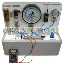
Типовой комплект учебного оборудования МСИ-Д «Методы измерения давления» предназначен для проведения лабораторных работ по изучению приборов измерения давления. Одновременно работы проводятся с группой из 2...3 обучаемых.
