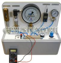
Типовой комплект учебного оборудования МСИ-Д «Методы измерения давления» предназначен для проведения лабораторных работ по изучению приборов измерения давления. Одновременно работы проводятся с группой из 2...3 обучаемых.
