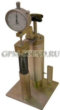
Комплекс обеспечивает определение жесткости витых пружин сжатия и растяжения в зависимости от геометрических параметров.
